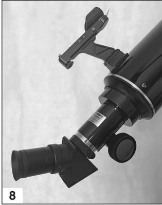
**Figura 8.** Monte la diagonal y un ocular en el enfocador como se muestra.
